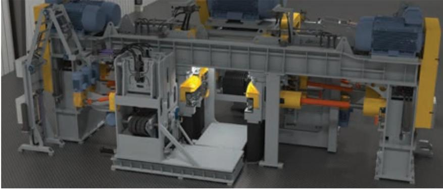
Le système de scie de forme compacte permet d'effectuer facilement et en toute sécurité les tâches d'entretien courantes, comme le changement de couteau et de scie, avec un plancher autodéployant, un système d'éclairage de service intégré (illustré ci-dessus) et un agencement ouvert.
