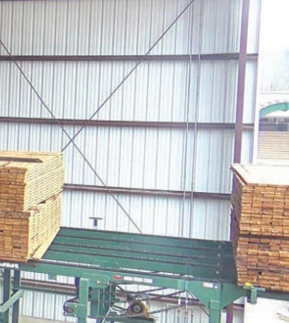
principal est de 20 rangées par minute, généralement avec un écart de 10 secondes entre les paquets. Le treuil basculant est muni d'une poutre d'inclinaison qui utilise des capteurs optiques pour niveler le déversoir avec le paquet entrant.
