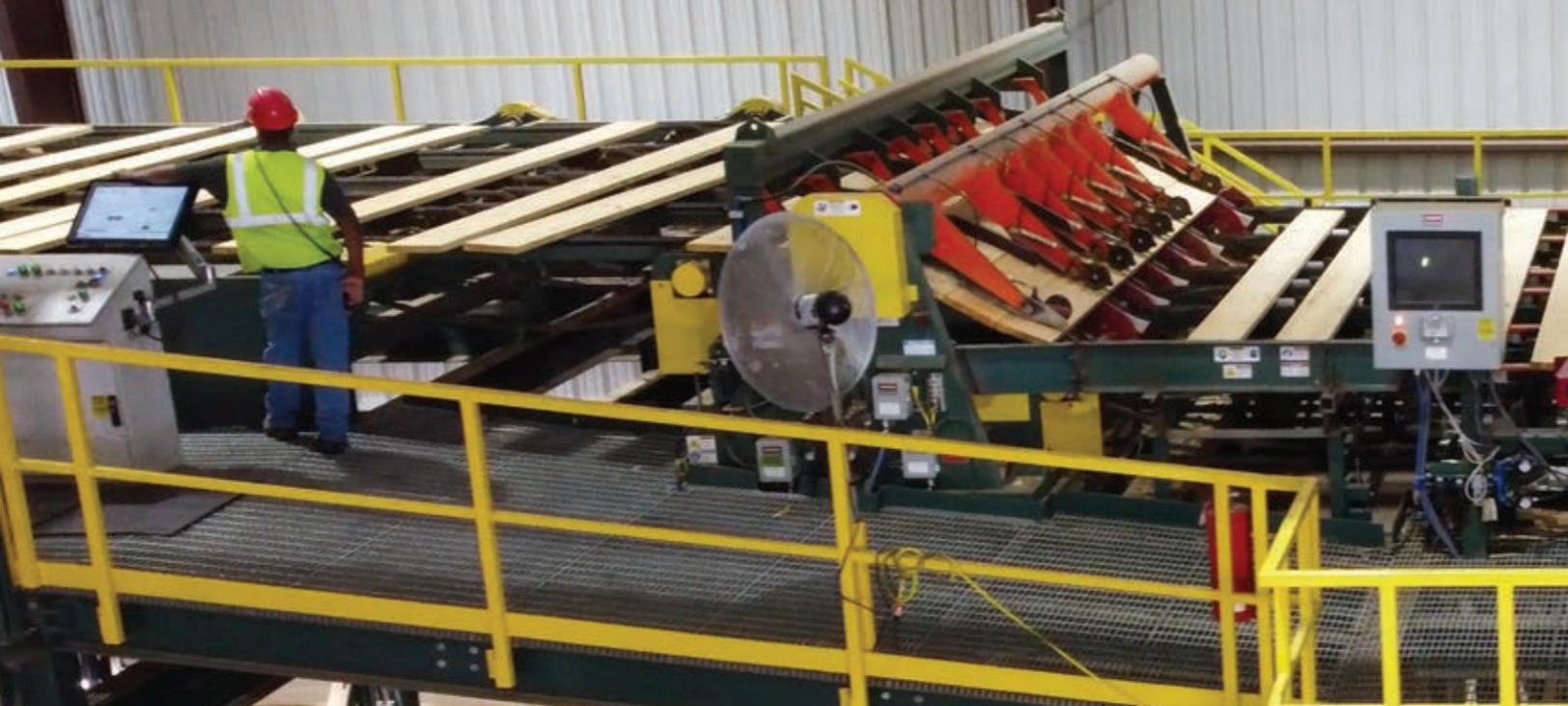
Ci-dessus : Chargeur à taquets à came quadruple
