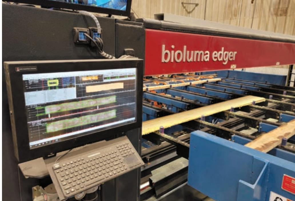
Le cadre de balayage est équipé de capteurs Bioluma 2900LV qui capturent des données de balayage géométrique et visuel de haute densité. Le système d'optimisation est doté d'une technologie d'IA à apprentissage profond qui garantit une reconnaissance très précise des caractéristiques des fibres de bois et des solutions de classement.
