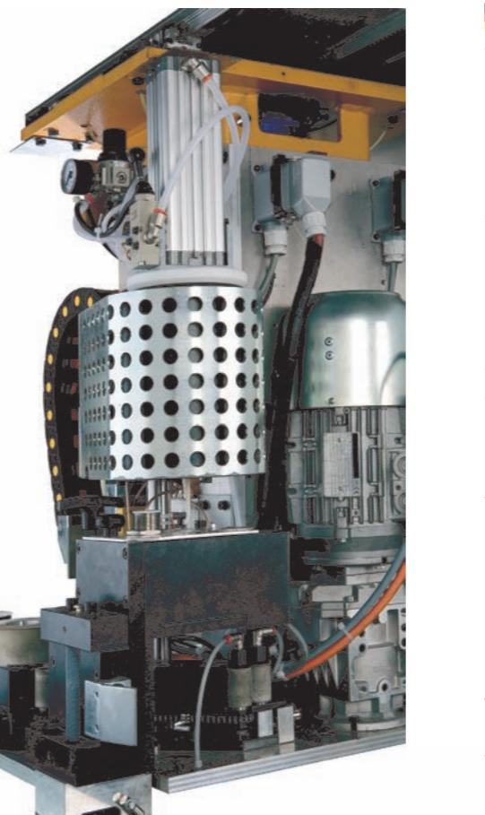
**Das neue Bearbeitungszentrum, dass die verschiedenen von den Barren produzierten Elemente gleichzeitig sägt und anleimt.**
