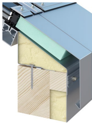
Montage sur un relevé en bois
