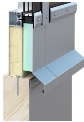
Montage vertical sur un relevé en bois
