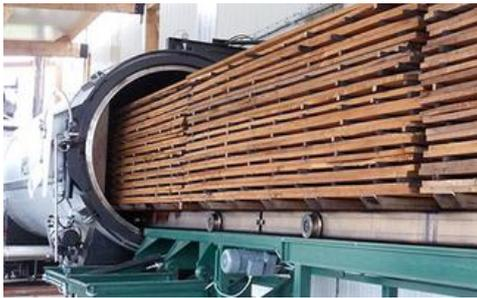
**Procédé :** Le bois est introduit dans le four de 12m<sup>3</sup> qui monte en température sous atmosphère contrôlée puis, par phases successives, à l'approche des T° souhaitées une quantité d'eau est injectée et vaporisée dans l'enceinte. Sous l'effet de la chaleur, les gouttelettes d'eau vont se dilater et la pression dans le four augmenter. Le traitement thermique à cœur débute et modifie durablement les caractéristiques du bois. S'ensuit une période de refroidissement du four.
