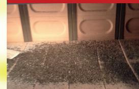
La réserve des combustibles permet un mélange végétal sans aucune restriction dans le silo de stockage 1000L fournit avec le bruleur biomeco, ainsi, plaquette forestière, bois déchiqueté, coquilles, noyaux, tourbe, miscanthus broyé, copeaux et sciure (à hauteur de 30%), peuvent être incorporés sans distinction. Le réglage sera affiné par l'automate séquentiel.
