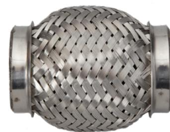
Doublure intérieure 3 épaisseurs/en interlock (pour une stabilité renforcée et un système de gaz d'échappement optimisé)
