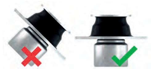
Il est important de respecter l'alignement entre le support antivibratoire et les supports de fixation. Si les supports sont mal alignés, le piston interne des supports hydrauliques peut toucher la paroi interne de la chambre hydraulique, ce qui augmente considérablement la rigidité des supports et réduit donc l'isolation des vibrations. Cela peut également produire un effet de martelage.
