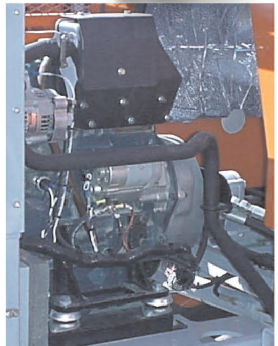
C'est un support idéal pour les moteurs où il est physiquement impossible d'installer des supports antivibratoires à la même hauteur que le vilebrequin.
