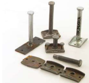
Début des années 90: premières études et prototypes des connecteurs du CTF pour les planchers en acier.
