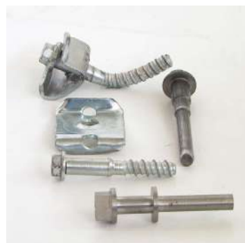
2002: prototypes du connecteur CTCEM pour planchers en briques et béton
