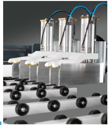
Pince de serrage à deux doigts avec réglage de pression.
