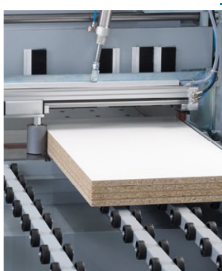
Dispositif d'appui angulaire pour un alignement doux et précis des panneaux.
