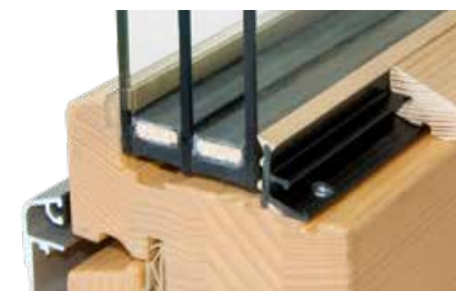
Exemple de mise en œuvre : FIXclip-Barre GLE 20 vissée.
