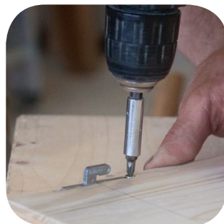
Insérer les pièces et visser ou coller
