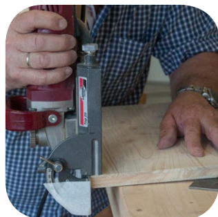
Réaliser les fraisages lamelles (profondeur 10 mm)
