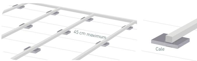
Les parquets/planchers massifs se posent sur une ossature en bois secs traités classe 2 (insecticide et fongicide). L'épaisseur des solives qui constituent l'ossature peut varier de 20 à 50 mm et leurs largeurs de 40 à 80 mm. La variation de ces dimensions est fonction du type de pose.
