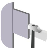
Il est recommandé de bien serrer les lambris lors de la pose. Utilisez une chute de lambris et un marteau pour emboîter les lames entre elles.
