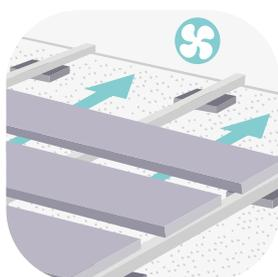
Prévoir une ventilation complète entre le sol et les lames de terrasse (ainsi qu'au niveau de la périphérie de l'ouvrage, passage d'une lame d'air obligatoire).
