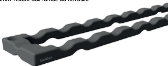
Le Liteau d'écartement 2.0 est fixé avec des vis Terrasotec de 4 mm de diamètre dans les trous prévus à cet effet (pour un Liteau d'écartement 2.0, 5 vis Terrasotec sont nécessaires). Le Liteau d'écartement 2.0 mesure 70 cm de long.
