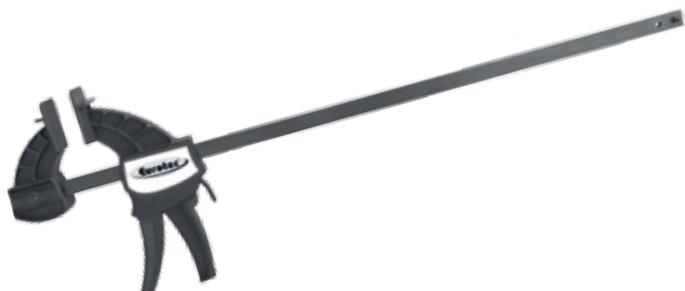
L'étrier de tension est un auxiliaire indispensable pour la pose de planches de terrasses. Utilisez au moins 4 étriers de tension afin de mettre les planches en forme sur toute leur longueur. Une pose en relation avec p. ex. les écarteurs permet d'atteindre un aspect de joints régulier avec les planches de terrasses posées droites.
