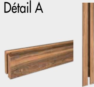
Pour une pose à la verticale, il faut préparer ce qui suit lors de la mise en place de Clip pour façade Rhombus Starter. Pour former un rebord anti-égouttage du profilé en losange, nous conseillons de réaliser un créneau à 15°. Grâce à une encoche de 4 mm de largeur dans le profilé bois réalisée dans les règles de l'art, le Clip pour façade Rhombus Starter s'insère correctement (cf. détail A).
