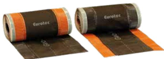
Le closoir de faîtage est composé d'un non-tissé PP (150 g) de grande qualité à haute capacité de diffusion et d'une tôle d'aluminium plissée. Grâce au non-tissé, la bande permet l'aération entre le chéneau et le faîte. Sans risque que l'eau ou de petits animaux ne pénètrent sous la structure du toit.
