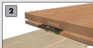
2 Installer le clip pour terrasse Eurotec sur l'ossature et prépercer la lame de terrasse pré-rainurée à un angle de 45° sur la traverse inférieure. Utilisez le foret 3 mm fourni.
