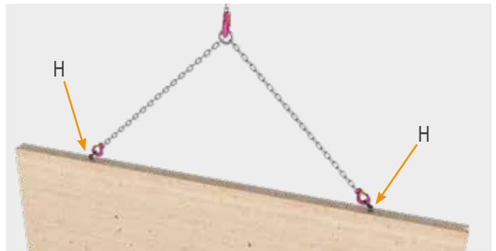
Élévation d'un mur en position dressée au moyen de deux ancrages de levage Mini montés et de broches de levage (H) au niveau du chant.
