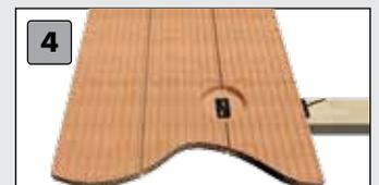
4 Pour la dernière lame de terrasse, il existe de nombreuses possibilités de montage. Notez que la dernière lame de terrasse doit être fixée à l'arête extérieure avec une vis à tête.
