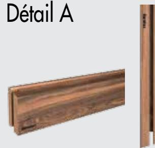
Pour une pose à la verticale, il faut préparer ce qui suit lors de la mise en place de Clip pour façade Rhombus Starter. Pour former un rebord anti-égouttage du profilé en losange, nous conseillons de réaliser un crénage à 15°. Grâce à une encoche de 4 mm de largeur dans le profilé bois réalisée dans les règles de l'art, le Clip pour façade Rhombus Starter s'insère correctement (cf. détail A).
