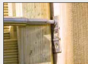
Fixez ensuite la surface de clôture au poteau en bois à l'aide de la ferrure. Nous recommandons d'utiliser 4 vis Clickyfi x par ferrure
