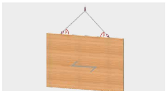
Mur ou poutre en bois lamellé collé en position dressée, orientation des fibres : horizontale
