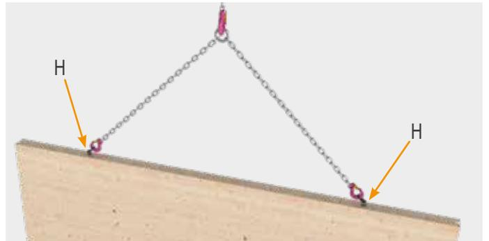
Élévation d'un mur en position dressée au moyen de deux ancres de levage montées et de broches de levage (H) au niveau du chant.
