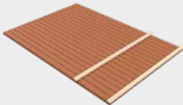
**3** Visser le profilé Rhombus du bas sur la structure porteuse, à l'aide des vis pour façades de type ZK.
