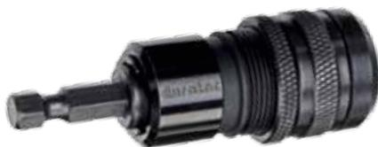
Le Screw Stop est la solution idéale pour enfoncer des vis dans le bois à profondeur régulière. Votre terrasse reçoit ainsi un aspect de surface agréable et régulier. La butée de profondeur à réglage progressif permet de régler simplement la profondeur d'enfoncement souhaitée. Lorsque celle-ci est atteinte lors du vissage, l'entraînement se débraie et la vis s'arrête. Vous n'êtes pas obligé de replacer l'appareil pour corriger le positionnement de la tête de vis.
