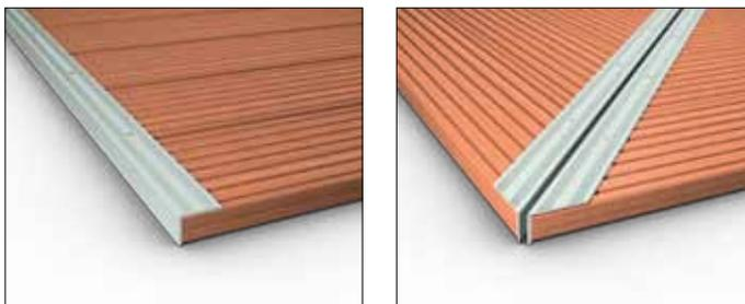
Le domaine d'utilisation du nouveau profilé de cornière est la finition ou le joint bout à bout du revêtement de terrasse. En raison de sa surface spécifique, le profilé de cornière est en mesure de garantir une tenue antidérapante, même dans des conditions humides. Grâce à sa forme géométrique ultra-plate, le profilé de cornière ne constitue pas un obstacle gênant.
