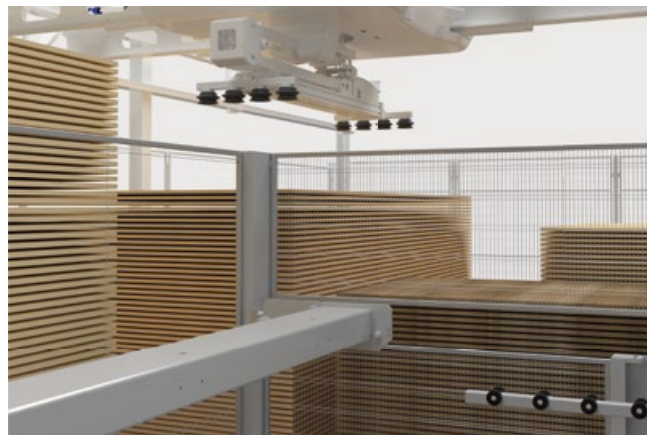
Un transport respectueux des matériaux à l'aide de ventouses à dépression
