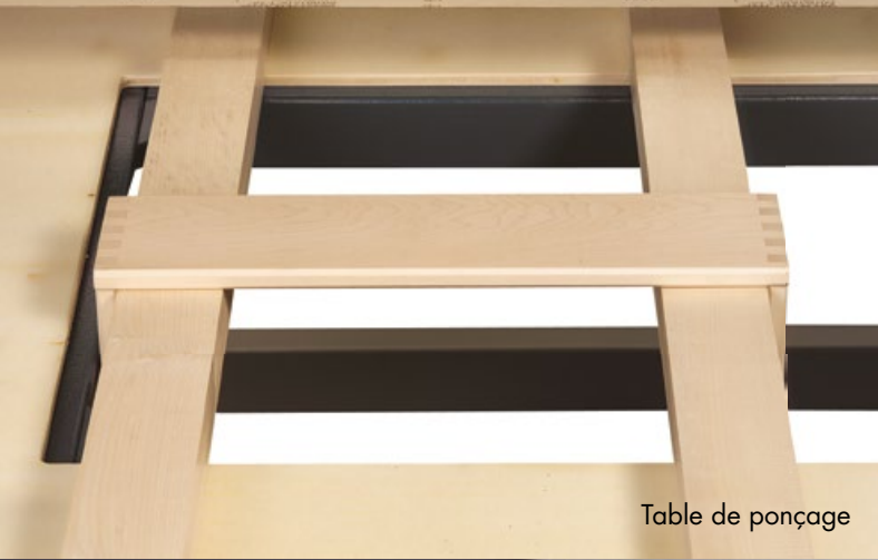
Support de ponçage doté d'un revêtement en graphite
