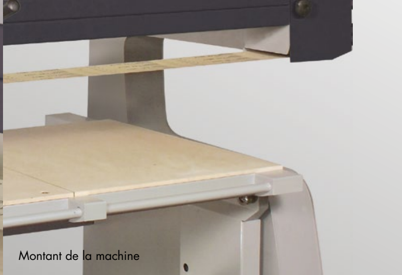
Support de ponçage doté d'un revêtement en graphite
