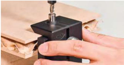
Percer un trou d'accès de 6 mm
