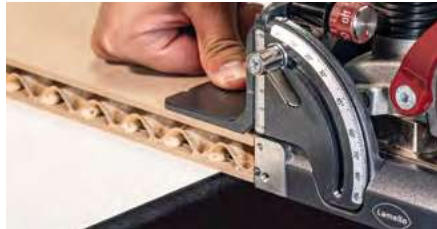
Aligner la Zeta P2 dans le trou à l'aide du clip de positionnement et fraiser la rainure suivante*
