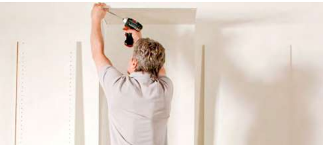
Préparer la visseuse sans fil et visser le coin avant. Le montage par une seule personne est donc possible sans aucun problème.
